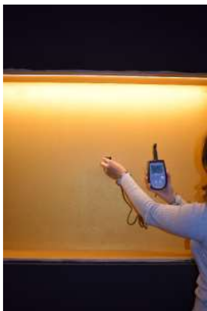
Misurazioni spot lux/UV con strumenti spot portatili in fase di allestimento della mostra
