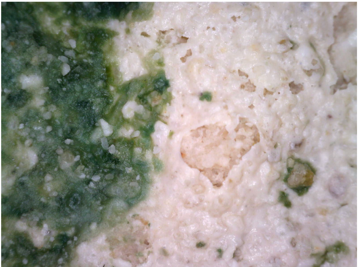
Figura 13: Immagine al microscopio digitale tra area pulita e non pulita.
