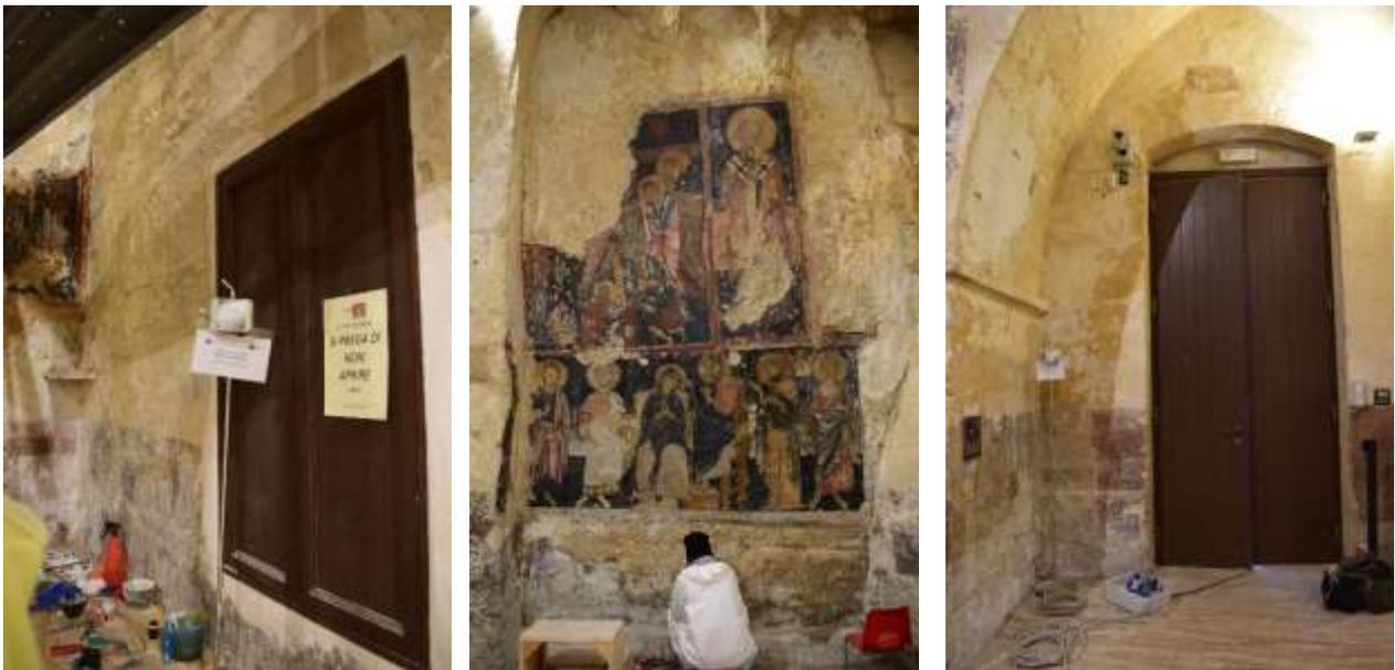
Postazioni di rilevamento termo-igrometrico D1 E D2 posizionate in prossimità dell'apertura della navata e della parete.
