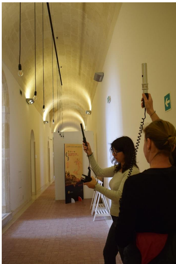
Misurazione di qualità dell'aria in corrispondenza dell'apertura della sala sul corridoio
